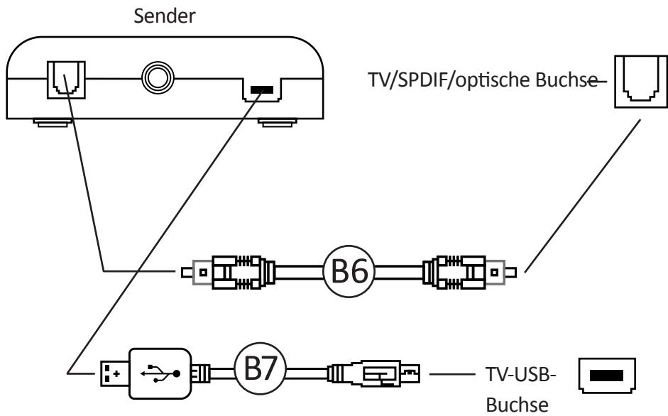
1. Optisches Kabel B6 mit dem SPDIF-Anschluss des DAC-Funksenders B5 anschließen.
