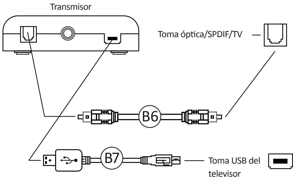
1. Conecte el cable óptico B6 a la toma SPDIF del transmisor DAC inalámbrico B5.
