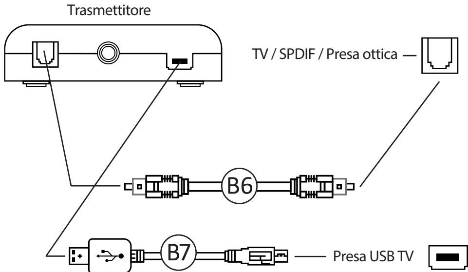
1. Collegare il cavo ottico B6 alla porta SPDIF del trasmettitore DAC wireless B3.
