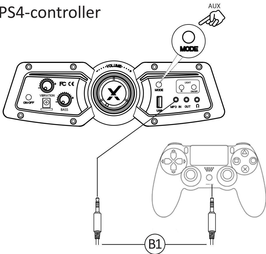
1. Verbind de B1-kabel met de onderzijde van de PS4-controller via de hoofdtelefoonaansluiting.
