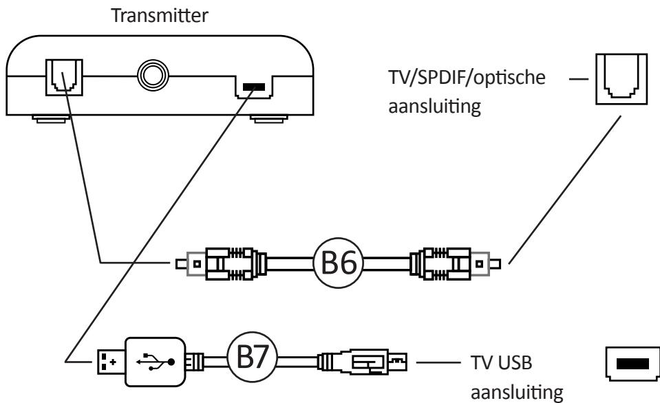
1. Sluit de B6 optische kabel aan op de SPDIF-poort van de B5 draadloze DAC-transmitter.
