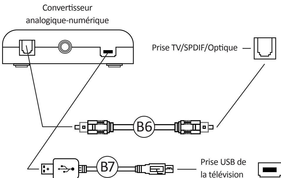
1. Connectez une des extrémités du câble optique B6 au port SPDIF du convertisseur analogique-numérique sans fil B5.
