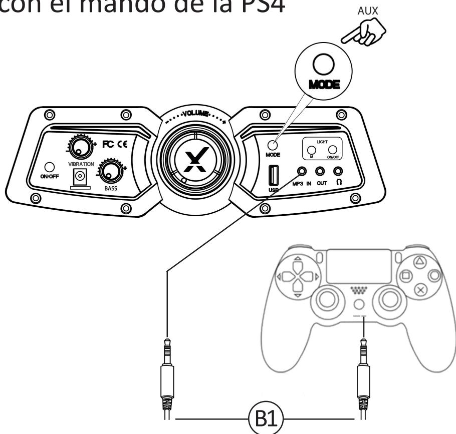
1. Conecte el cable B1 a la toma de auriculares ubicada en la parte inferior del mando de la PS4.
