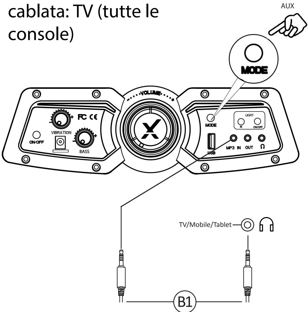
1. Collegare il cavo B1 alle prese INPUT MP3 del pannello di controllo dell'oscillatore X.
