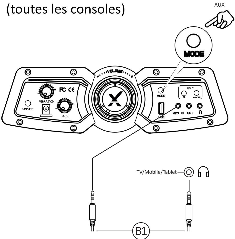
1. Connectez le câble B1 aux prises d'entrée (INPUT) RCA du panneau de commande du X Rocker.
