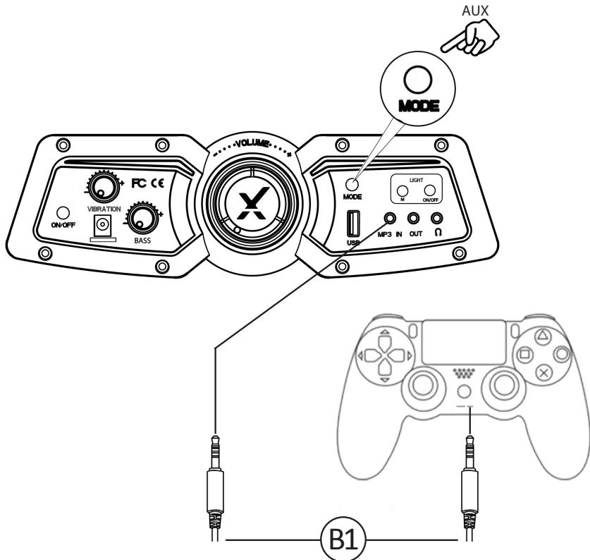
1. Kabel B1 mit der Kopfhörer-Buchse an der Unterseite des PS4-Controllers verbinden.
