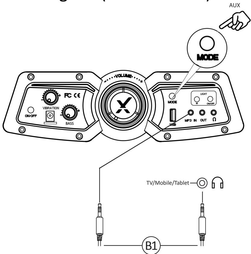
1. Kabel B1 mit den Cinch-INPUT-Buchsen des X-Rocker-Bedienfeldes verbinden.
