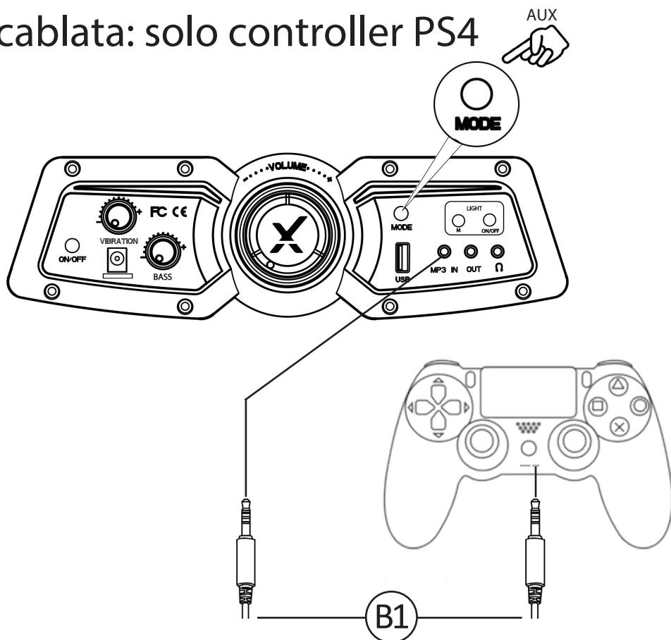
1. Collega il cavo B1 alla parte inferiore del controller PS4 tramite la presa dell'auricolare.
