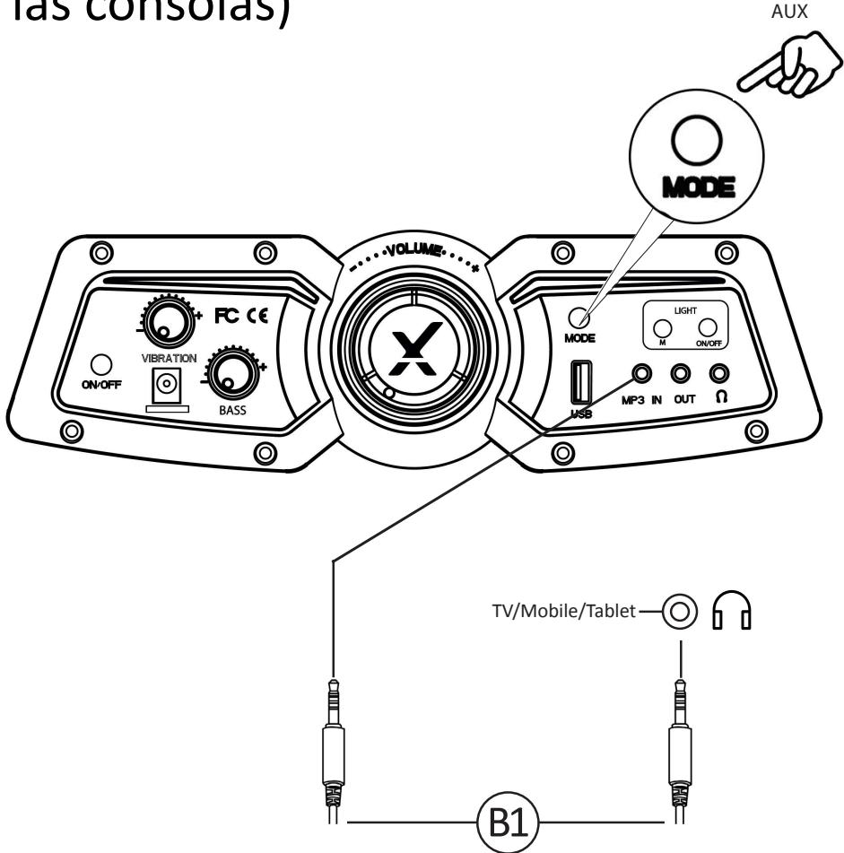
1. Conecte el cable B1 a las tomas de entrada RCA del panel de control de la X Rocker.
